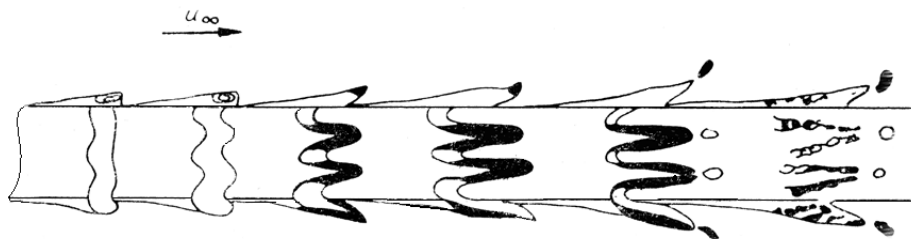
Рис. 7. Визуализация процесса образования \Lambda -образных вихрей с закругленной головкой на теле вращения. Рисунок из работы [7]. Цитируется по работе [1]
