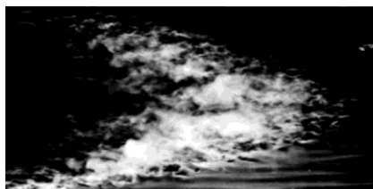
а) в воздухе; визуализация осуществляется при помощи дыма в воздухе, освещаемого вспышкой; фото R. E. Falco; рисунок из работы [3]
